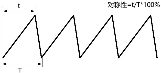
点击**对称性**项的输入框设置对称性，对称性的可设置范围为 0.1% 至 99.9%，默认值为 50%，分辨率 0.1%。实际应用中锯齿波对称性受周期限制： $20 \text{ ns} \leq \text{对称性} * \text{周期} \leq \text{周期} - 20 \text{ ns}$ 。
