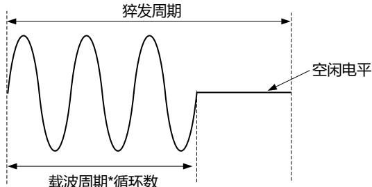
启用猝发功能后, 在猝发设置界面点击**空闲电平**下拉菜单选择相应的选项:
