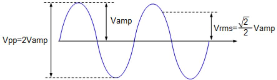
根据上图, 可以推导出正弦波 V<sub>pp</sub> 与 V<sub>rms</sub> 之间换算关系满足如下关系式:
