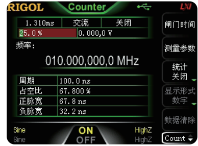
标配 7 digits/s, 200MHz 带宽的频率计
