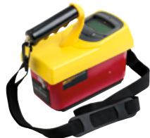
自动测定量程的451B用于检测 $\beta$ 、 $\gamma$ 和X射线源的剂量率和累积剂量。451B优秀的现场巡测能力使其广泛的应用于各个行业，包括：警察和消防部门、X线设备制造商、政府机构、监督人员、应急响应和HAZMAT(危险品)处置人员、核医学实验室、医院辐射安全官员，以及核电站工作人员。
