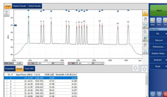
FTBx-5235显示通道功率、通道波长和OSNR。上：OSA在测试CWDM网络时的显示结果。下：OSA在测试DWDM网络时的显示结果。
